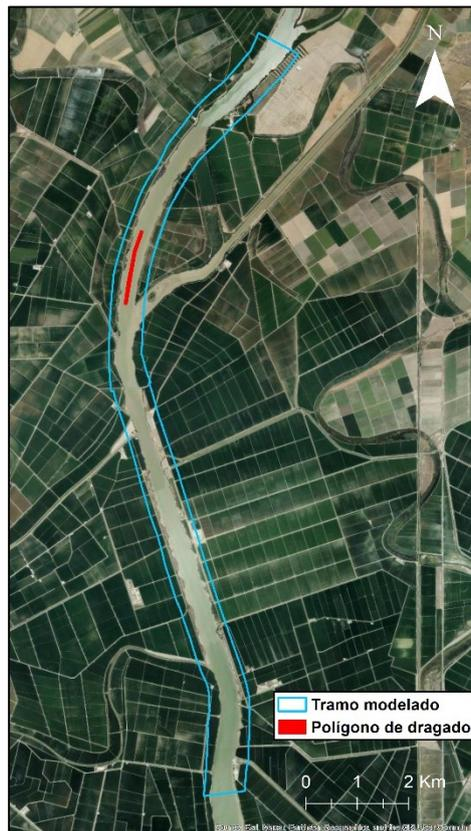
Figura 2. Localización del polígono de dragado en Los Olivillos y delimitación del tramo modelado.
